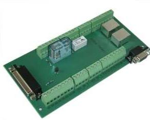
Das Modul bietet abgesetzt von der Zentraleinheit weitestgehend identische Anschlüsse zu den gleichnamigen Buchsen auf der Rückwand der EVA 16 M/S.
